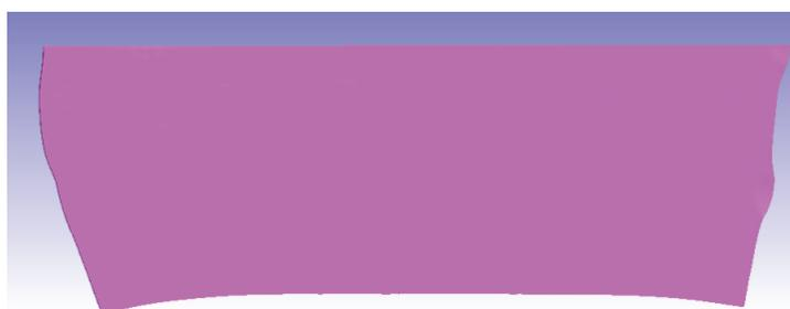
**Рис. 5.** Вид полосы сверху после моделирования дальнейшей прокатки в гладких валках (вторая прокатка)
